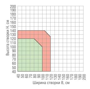
Окно одностворчатое поворотное / наклонно-поворотное, классы А-Д по сопротивлению ветровой нагрузке
