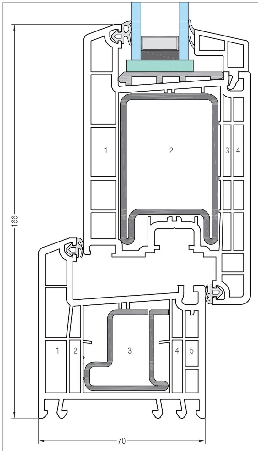
**Глубина 70 мм, 5-камерное строение коробки, 4-камерное строение створки:**
